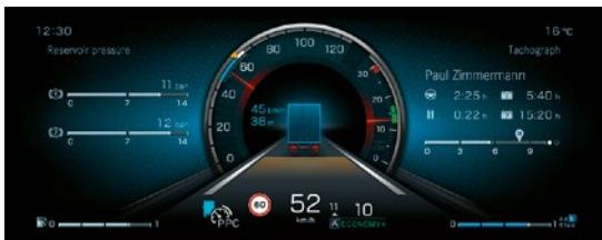
**Multimedia-Cockpit.** An die Stelle des klassischen Kombiinstruments mit Tachometer, Drehzahlmesser und Tankanzeige tritt das hochauflösende Primärfarbdisplay. Es informiert übersichtlich über alle wesentlichen Fahr- und Betriebszustände.
