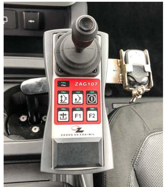
*Einbau in der Mittelkonsole rechts.*
