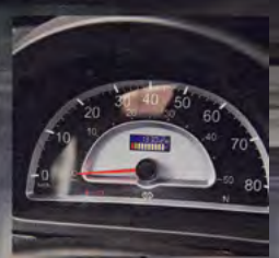
A Balkenskala für die Reichweite. Mit dem Lithium-Ionen-Akku erhält man eine detailliertere Darstellung
