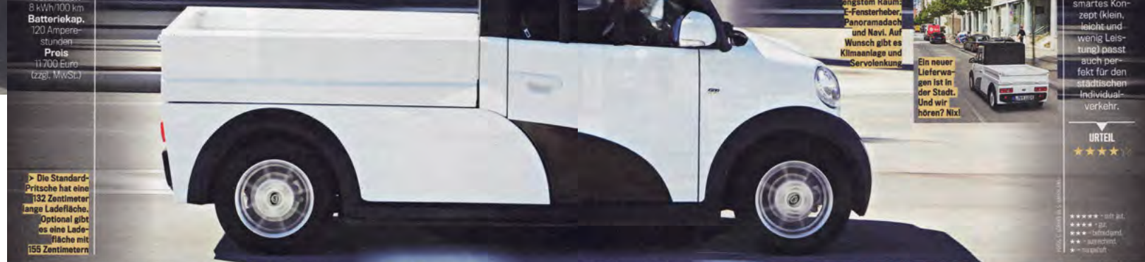
Der E-Motor mit 7,5 kW Leistung treibt die Hinterräder an, stößt beladen schnell an seine Grenzen
