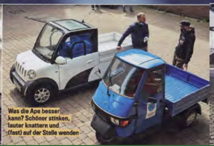
Der E-Motor mit 7,5 kW Leistung treibt die Hinterräder an, stößt beladen schnell an seine Grenzen
