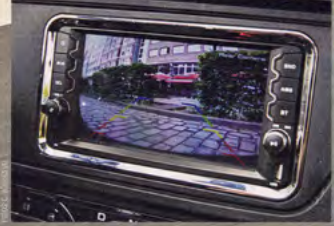
< Rückfahrkamera: serienmäßig und atmöhrlich, speziell bei Aufbauten mit Koffer. Zur Sicherheit piepst ARI noch ganz nervig
