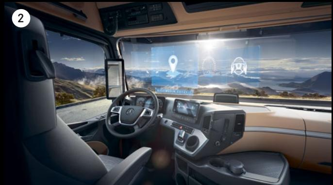
**2) Multimedia-Cockpit.** An die Stelle des klassischen Kombiinstruments mit Tachometer, Drehzahlmesser und Tankanzeige tritt das hochauflösende Primärfarbdisplay. Es informiert übersichtlich über alle wesentlichen Fahr- und Betriebszustände.
