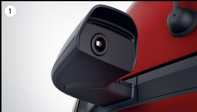
**1) MirrorCam.** Sie ersetzt die herkömmlichen Haupt- und Weitwinkelspiegel. Aufgrund ihrer stromlinienförmigen Bauweise trägt auch sie dazu bei, dass der neue Actros weniger verbraucht als sein Vorgänger. Beim Handling und bei der Sicherheit bietet das System ebenfalls grosse Vorteile.
